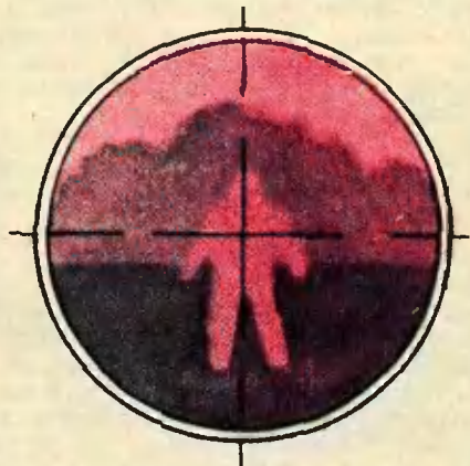
Силуэт человека виден в полной темноте с помощью прибора ночного видения, который воспринимает инфракрасные (тепловые) лучи.
