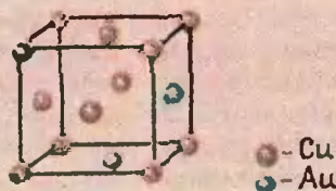
Рис. 2. Неупорядоченный сплав замещения медь — золото.
